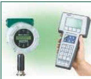
Les débitmètres multi variable Pro-V™ de Vortek instruments combinent 3 éléments primaires de mesure : un capteur Vortex de vitesse, une sonde à résistance pour la température et un capteur de pression, de façon à pouvoir mesurer des débits massique de gaz, liquides et vapeur. Les systèmes qui utilisent des capteurs externes peuvent ne pas compenser parfaitement du fait des variations des conditions de process entre le point de mesure de vitesse et les points
