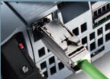
Le contrôleur d'E/S PROFINET permet la connexion d'appareils PROFINET. L'interface PROFINET intégrée peut être utilisée aussi bien pour la programmation que pour la communication IHM
